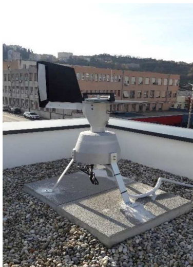
Slika 2. Aparat za uzorkovanje peludi
