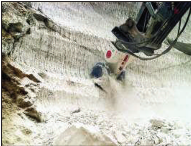
Slika 1.3.1. Rad bagera s hidrauličkom glodalicom na pridobivanju mineralne sirovine
