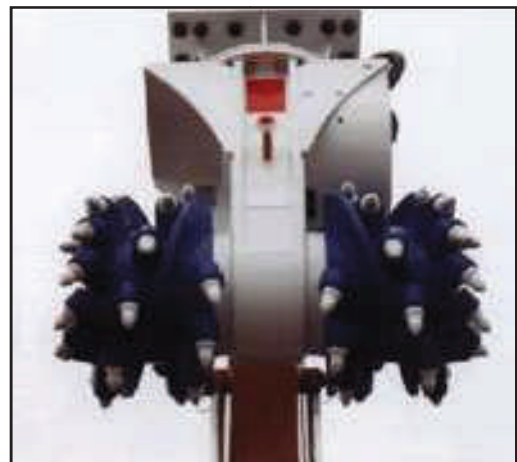
Slika 1.3.1. Rad bagera s hidrauličkom glodalicom na pridobivanju mineralne sirovine
