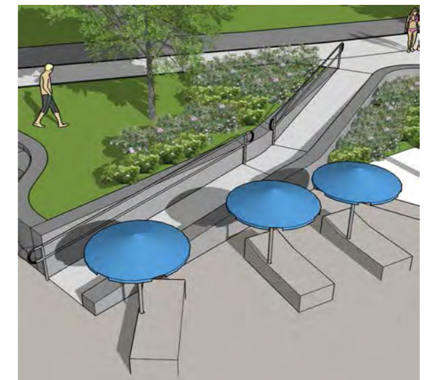
Slika 20: Prilazna rampa s rukohvatom - prilaz plaži
