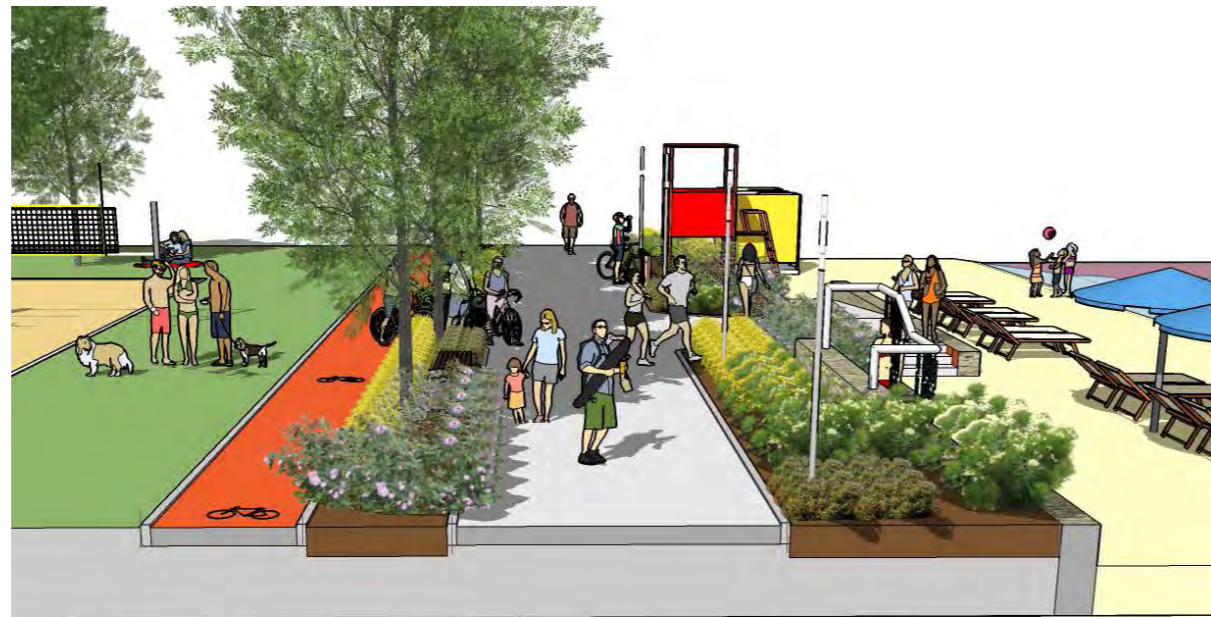
Biciklistička staza (1,5m) | Zaštitni zeleni pojas | Pješačka staza (min. 3,5m) | Zaštitni zeleni pojas Setnica
