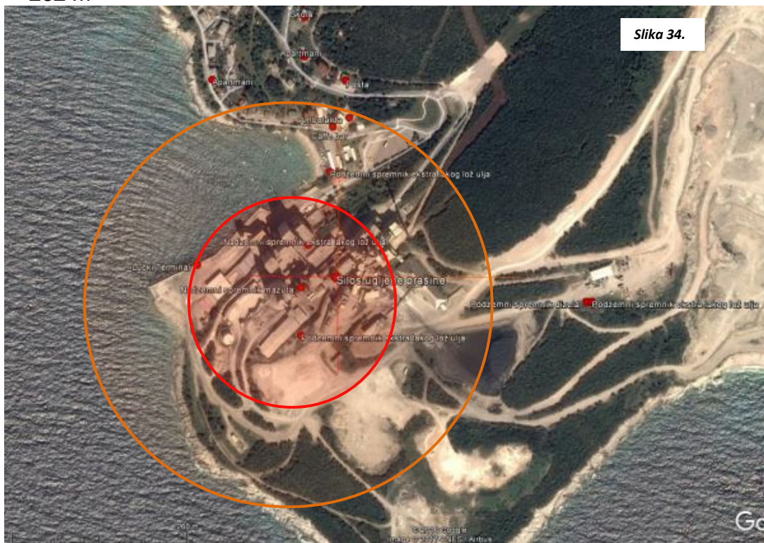
Zone ugroženosti u slučaju eksplozije 26 t ugljene prašine u silosu ugljene prašine
