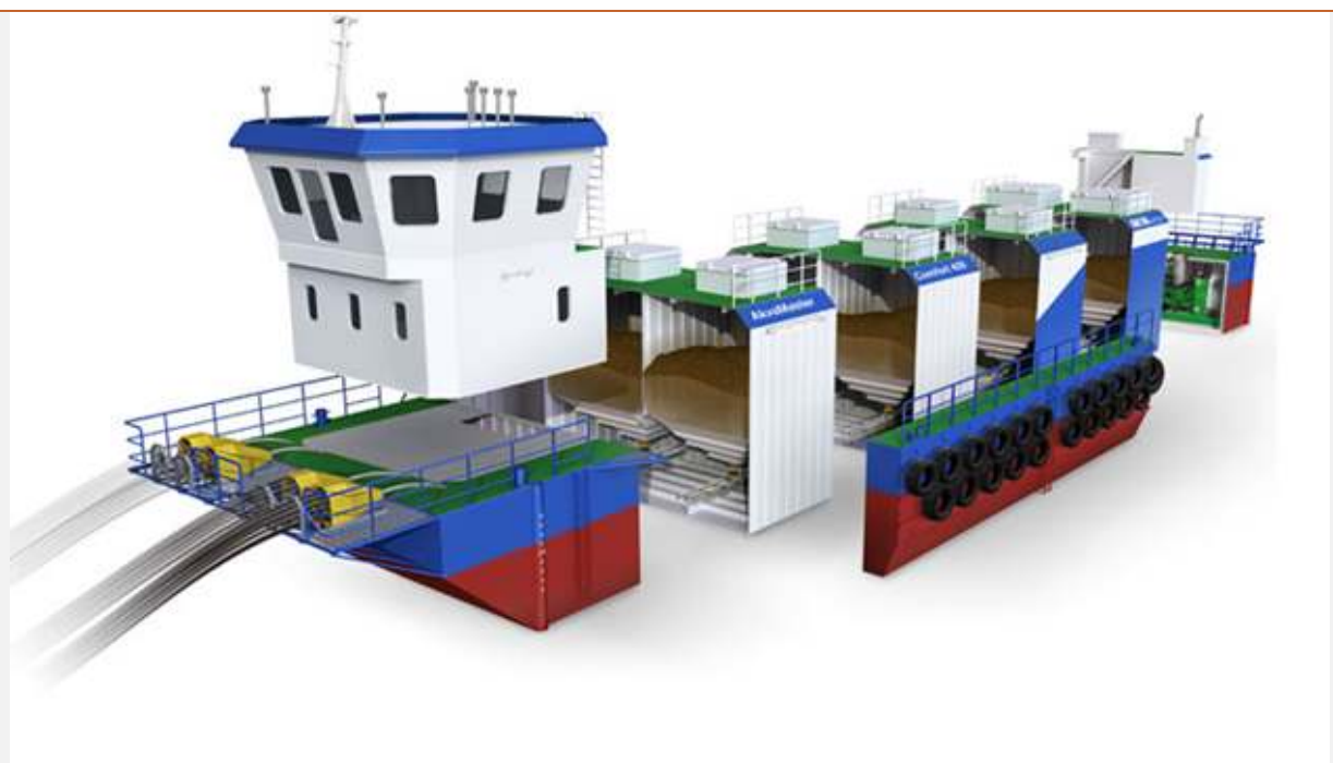
Slika 1.4.2.-5. Presjek barže sa skladištima hrane koja se plastičnim cijevima dostavlja u svaki kavez.
