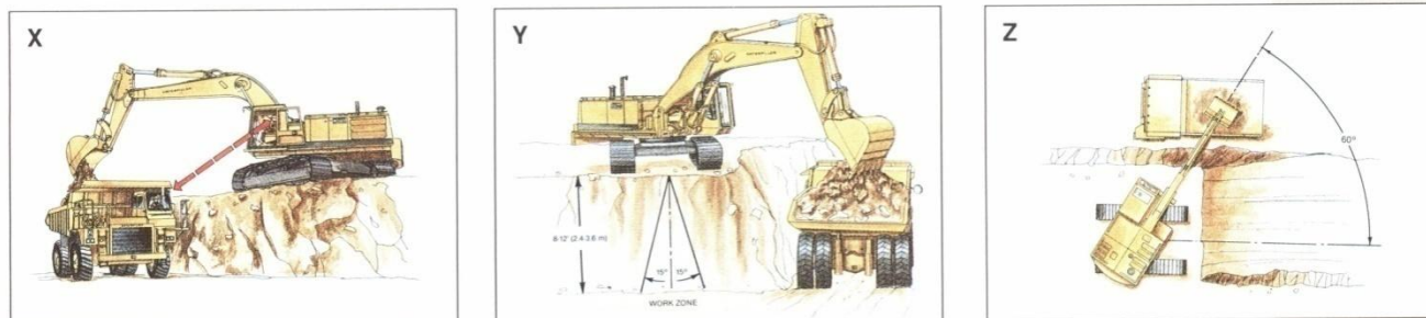
Slika 1.3.1.6. Shematski prikaz utovara tehničko-građevnog kamena
