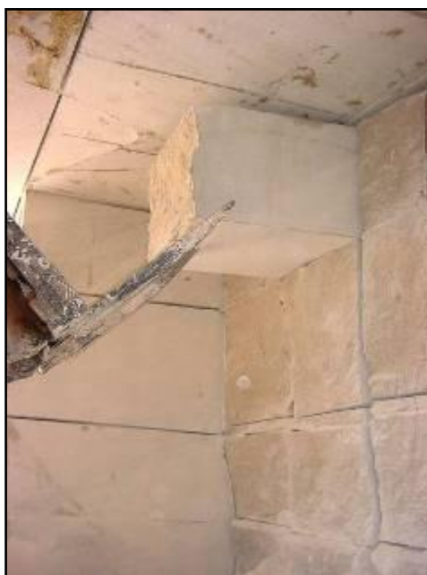
Slika 2.1.2. Prikaz vađenja blokova iz ostvarenog napretka.
