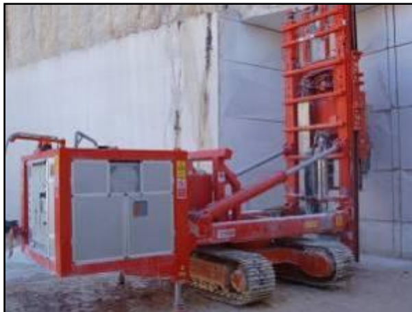
Slika 2.1.1. Primjer samohodne lančane pile za izradu horizontalnih i vertikalnih rezova
