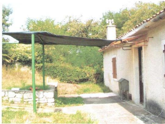
Slika 1: Uređaj za uzorkovanje zraka u naselju Cere kraj Labina. Pored kuće je košara s posudom za uzorkovanje taložne tvari, a na nadstrešnici ulazna cijev za uzorkovanje zraka. Volumetrijski aparat za uzorkovanje zraka smješten je u metalnoj kutiji.
