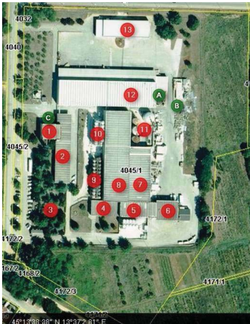
Slika 6. Situacija Vinarije i uljare Agrolaguna d.d. (1 – kotlovnica, 2 – kancelarije, 3 – postojeća obrada otpadnih voda, 4 – upravna zgrada, 5 – prešanje grožđa, 6 – prijem i prerada grožđa, 7 / 8 – fermentacija i skladištenje vina, 9 / 10 – skladištenje gotovog vina, 11 – stara infrastruktura (planirana prenamjena), 12 – punionica vina sa skladištem gotovih proizvoda i repromaterijala, 13 – uljara; A – baliranje i skladištenje papira, kartona i folije, B – miješani komunalni otpad, C – zauljeni i ostali opasni otpad)
