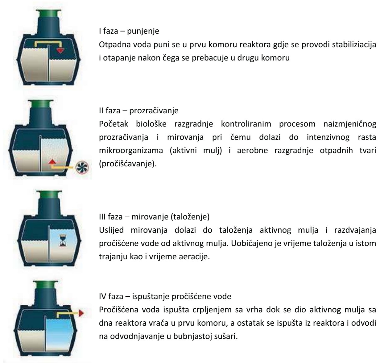
Slika 25. Faze rada SBR reaktora
